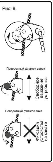
**Рис. 9. Ограничения при эксплуатации.**
