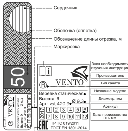
Рис. 1. Составные части и маркировка изделия
